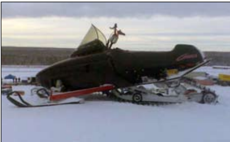
Omistaja: Wille Hahti Jatkettu 345 cm pitkäksi, tela 04-9819 Etupukki laskettu 3 cm, takapukkia on siirretty taaksepäin ja laskettu sitäkin. 8-hampaiset vetopyörät. "Parasta mitä kelmalle voi tehdä"
